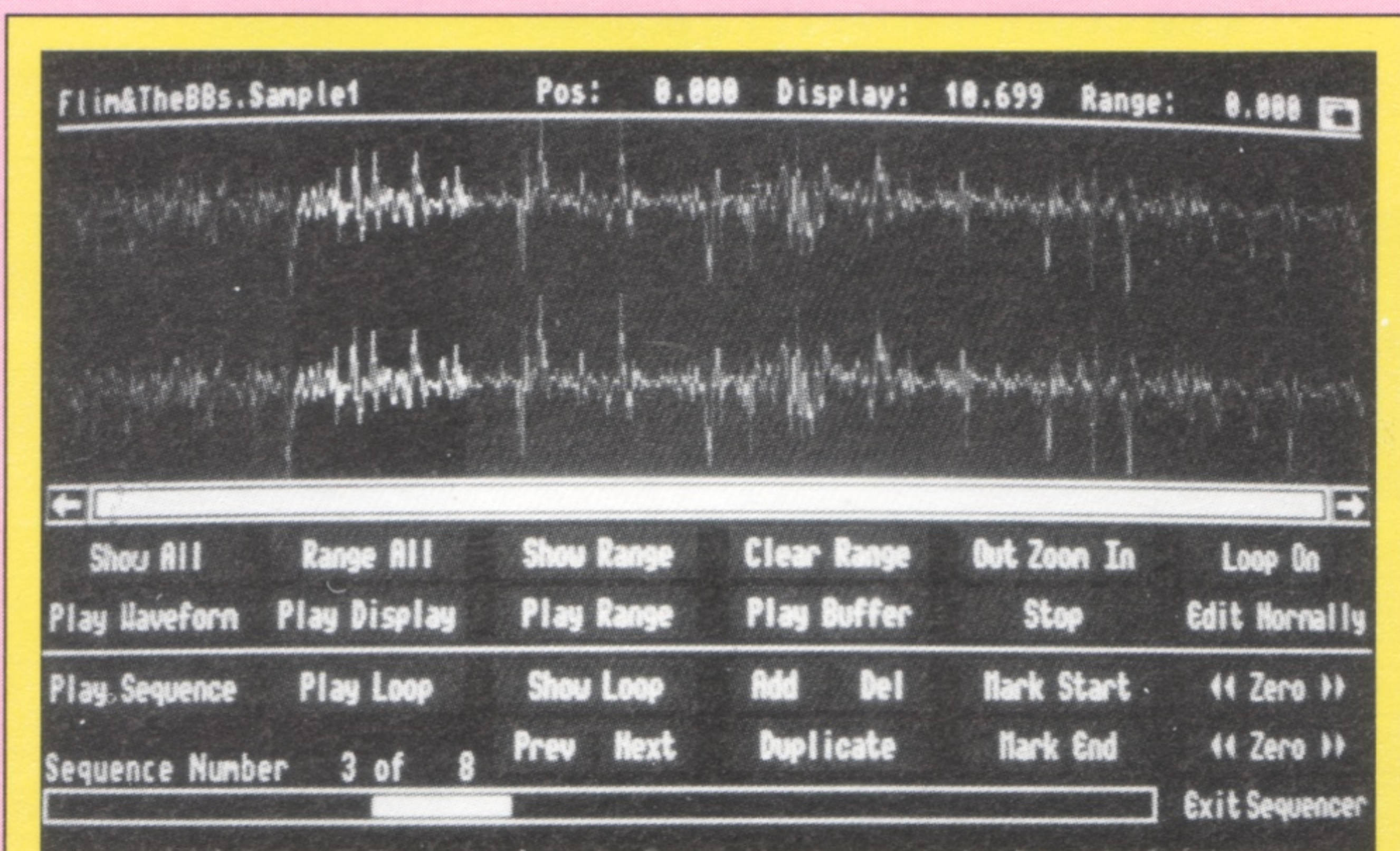
Il Sequencer, che consente di programmare l'esecuzione di sequenze di spezzoni differenti della stessa forma d'onda.
